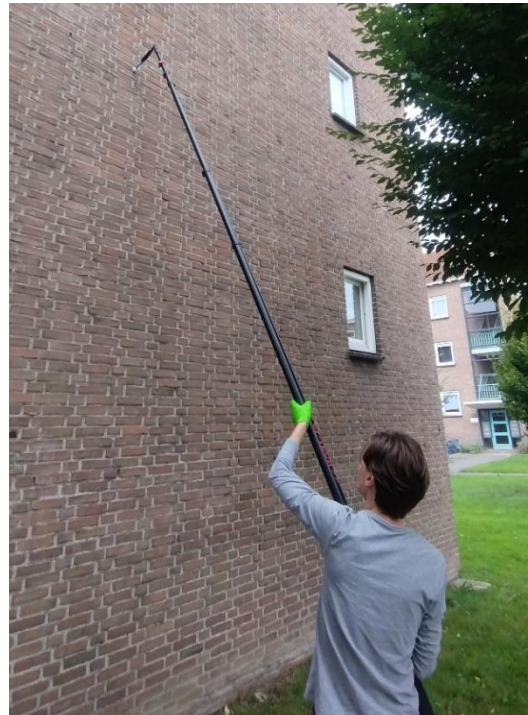
Figuur 2. eDNA monsternamen met behulp van een spons. Hierbij wordt de spons gemonteerd op een telescoopstok.
